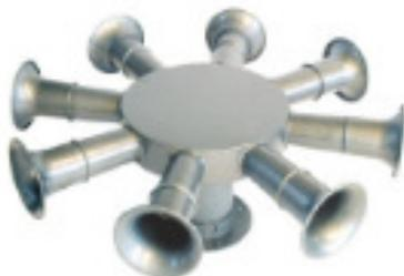
Sirene eletromecânica de alto rendimento, com 8 trombetas e som multidirecional. Possui: flange, hélice e base de fixação em alumínio, montados em um motor trifásico de 2 HP.
