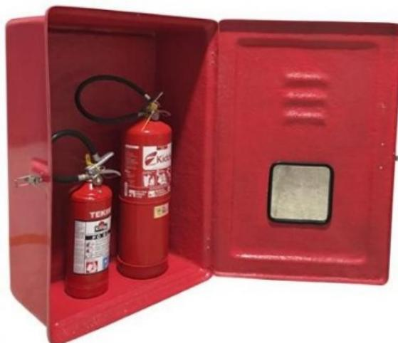
Os abrigos em fibra de vidro, para extintor, são próprios para ambientes corrosivos ou sob ação das intempéries. Fabricados com dobradiças e fechaduras em aço inox 304, fixados com rebites em alumínio, puxador em Poliamida + PRFV e visor de poliestireno cristal 1,5mm com perfil de borracha “S” para acabamento e vedação.
