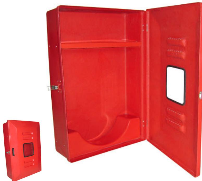
Armários para mangueiras em PRFV (Plástico Reforçado com Fibras de Vidro). Dispensam pintura, pois são pigmentados durante a fabricação com gel coat aditivado contra raios UV's.
