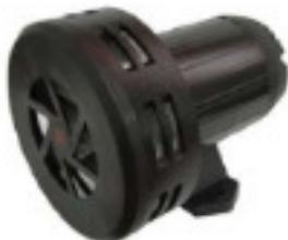
Sirene eletromecânica unidirecional montada em tubo de alumínio extrudado com superfície pintada em preto. Possui flange, hélice, tampa frontal, tampa traseira e base de fixação injetadas em nylon com fibra de vidro.
